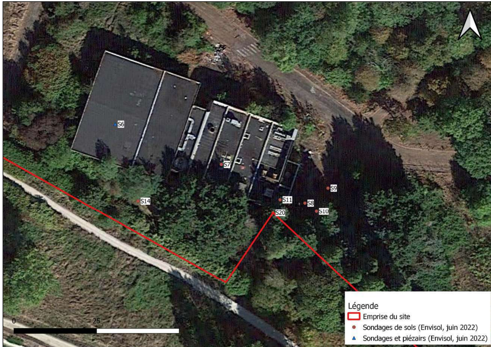
Figure 21. Localisation des investigations réalisées au niveau du bâtiment CT1
