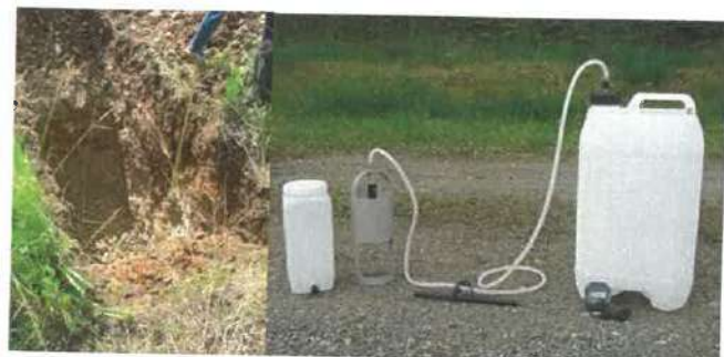
Exemple de test de perméabilité (PORCHET)
